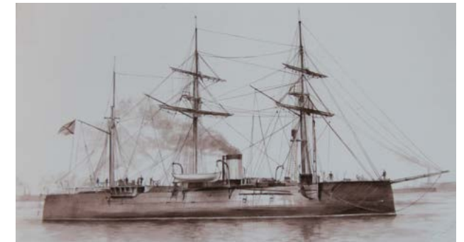
Броненосец береговой обороны «Кремль» водоизмещением 4323 тонны. Изготовлен на Невском заводе в 1865 году
