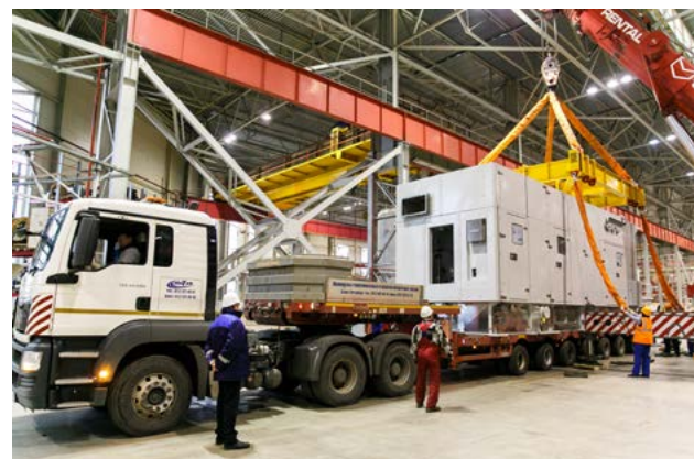
Транспортировка ГТУ T16 в состоянии полной заводской готовности
