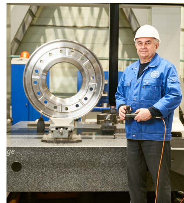
Проведение измерений на координатно-измерительной машине
