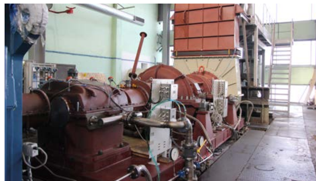
Испытательный стенд осевых компрессоров
