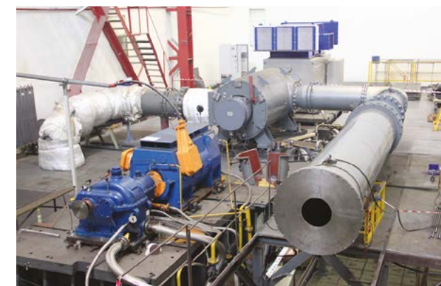
295 СПЧ 3.0 на испытательном стенде Невского завода
