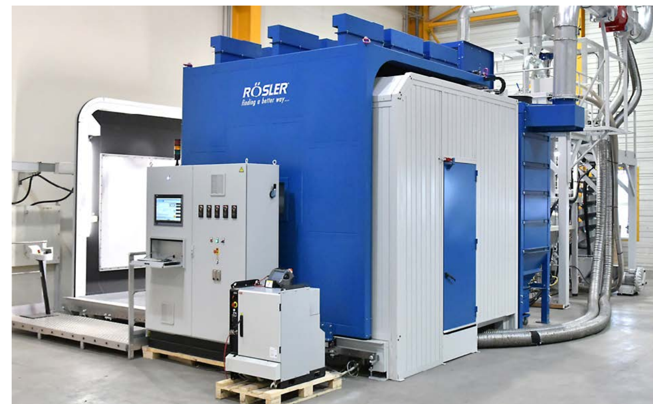
Внешний вид роботизированной установки дробеструйного упрочнения Roesler ALS 2800 RP
