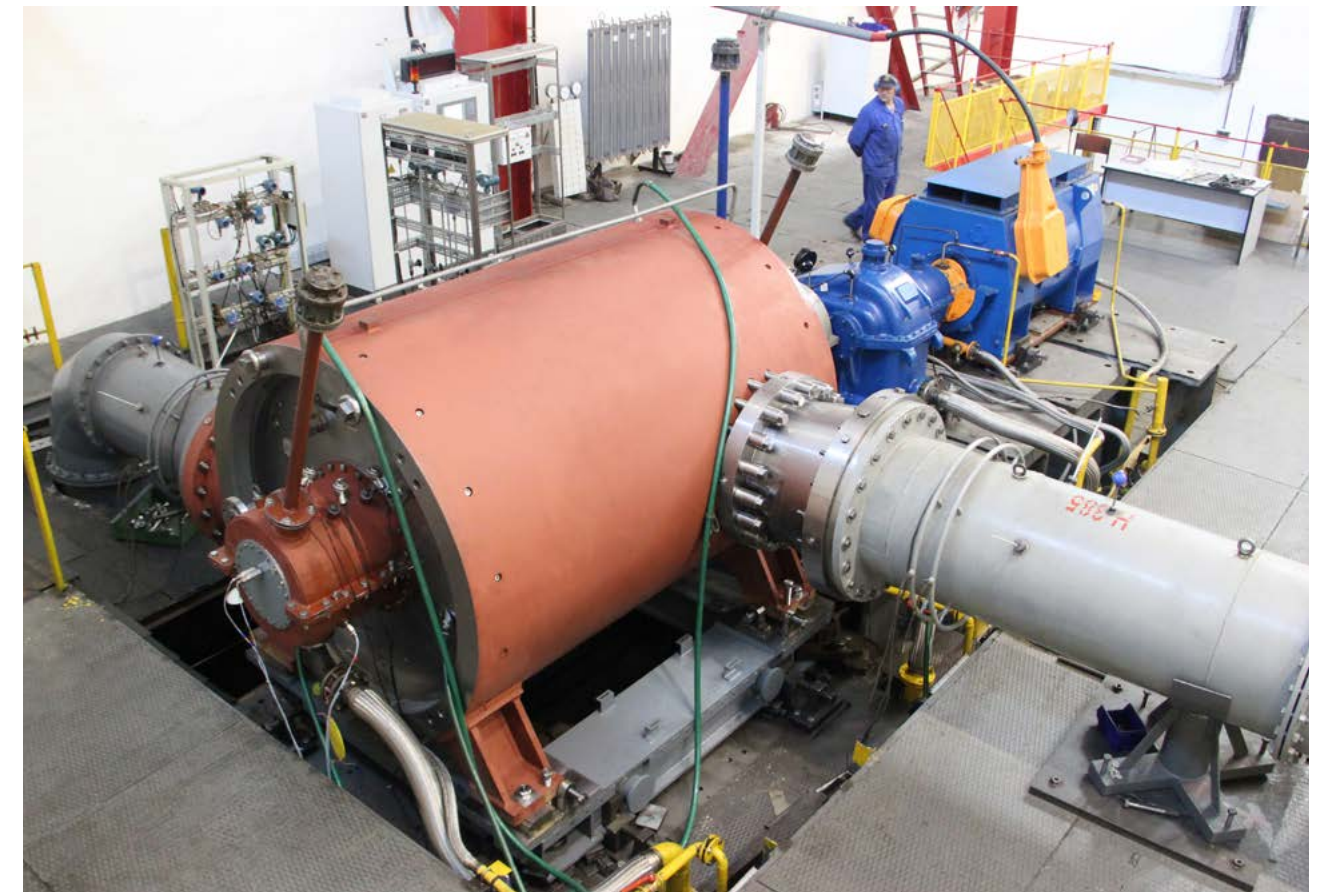
Испытательный стенд центробежных компрессоров
