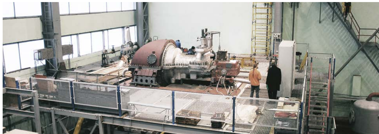
Испытательный стенд паровых турбин
