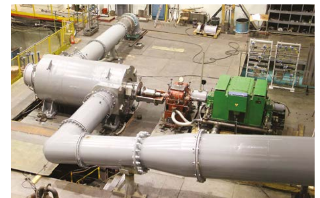
СПЧ на испытательном стенде Невского завода
