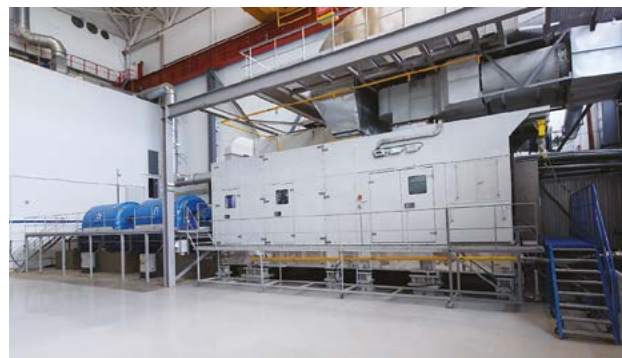
Испытательный стенд газовой турбины Т16
