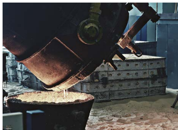
Разливка металла на плавильно-заливочном участке «Невского завода»
