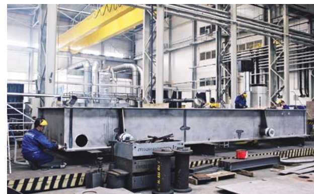
Изготовление рамы вспомогательных устройств
